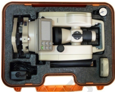
Рис. 3. Порядок укладки теодолита в футляр.
